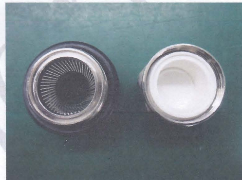
图 15 测试后 5# 无进水
