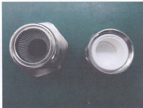
图 14 测试后 4# 无进水
