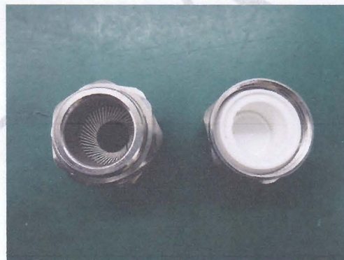
图 16 测试后 6# 无进水
