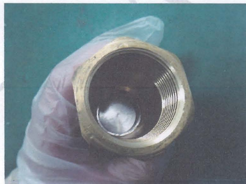
图 27 测试后 4# 无进水
