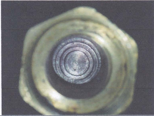
图 29 测试后 5# 无进水
