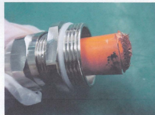
图 22 测试后 2`# 无进水
