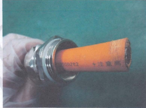
图 26 测试后 4# 无进水
