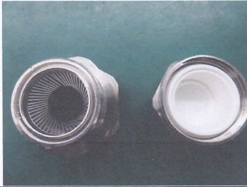
图 12 测试后 2# 无进水
