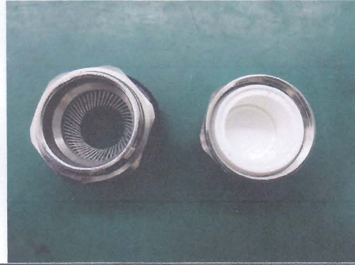
图 13 测试后 3# 无进水
