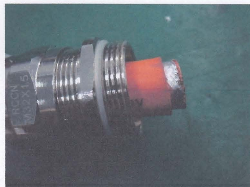
图 28 测试后 5# 无进水
